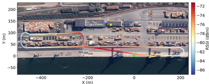
18 pav. LoRaWAN signalo stiprumo rezultatų vizualizavimas palydovinėje nuotraukoje
